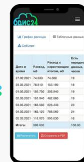
УСПД ОДИС-RS считывает данные с прибора учёта через интерфейс RS-232 или RS-485 и с заданной периодичностью передает показания в личный кабинет пользователя в системе облачной диспетчеризации «ОДИС»
